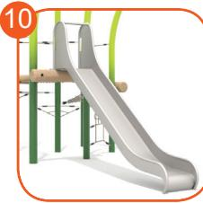
Glissière en acier inoxydable AISI 304. La tôle a une épaisseur de 2 mm et l'extrémité est finie avec une bande en tube de 33,7 mm.
