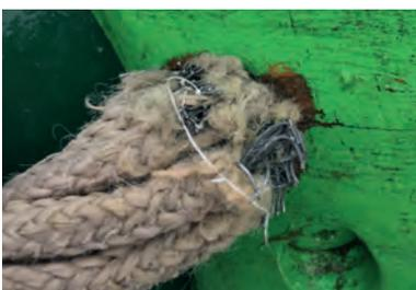
Remplacer le cordage (toron d'acier visible)
