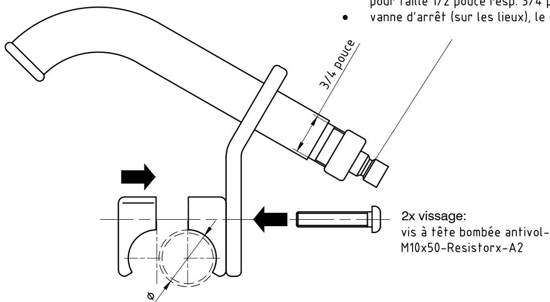
diamètre extérieur du tube:  $\varnothing 33,7$
