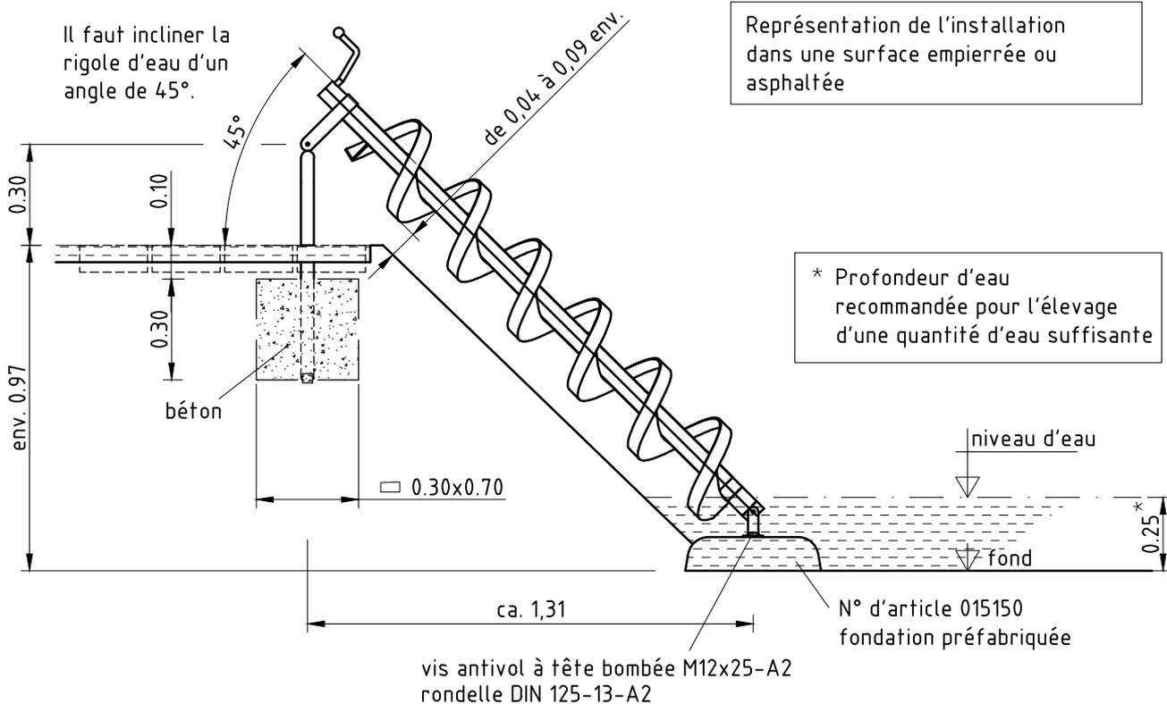
écoulement d'eau modelé (p. ex. pavés de petite taille)
