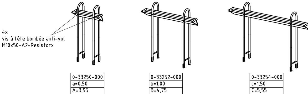
Installer la rigole avec une inclinaison d'un degré (1°) dans le sens d'écoulement.
