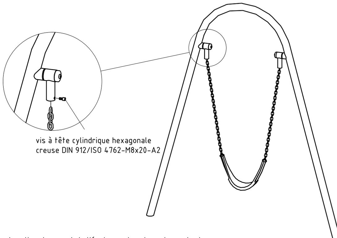
vis à tête cylindrique hexagonale creuse DIN 912/ISO 4762-M8x20-A2
