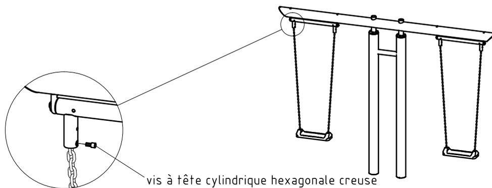
vis à tête cylindrique hexagonale creuse
