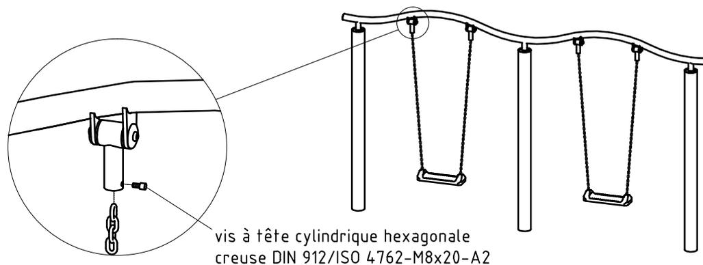
vis à tête cylindrique hexagonale creuse DIN 912/ISO 4762-M8x20-A2
