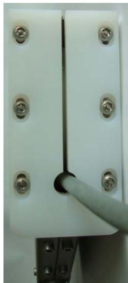
Pour garantir une marche souple du chariot et pour éviter l'endommagement du câble, on peut régler la hauteur des brides latérales du boîtier.
