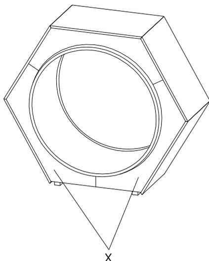
1. Déterminer l'emplacement de l'équipement en tenant compte de la surface nécessaire. Il faut, en tout cas, recouvrir la surface de heurt d'un revêtement amortissant qui correspond aux exigences à une hauteur de chute critique de 1000 mm (voir EN 1176-1).
