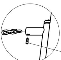
vis à tête cylindrique hexagonale creuse
