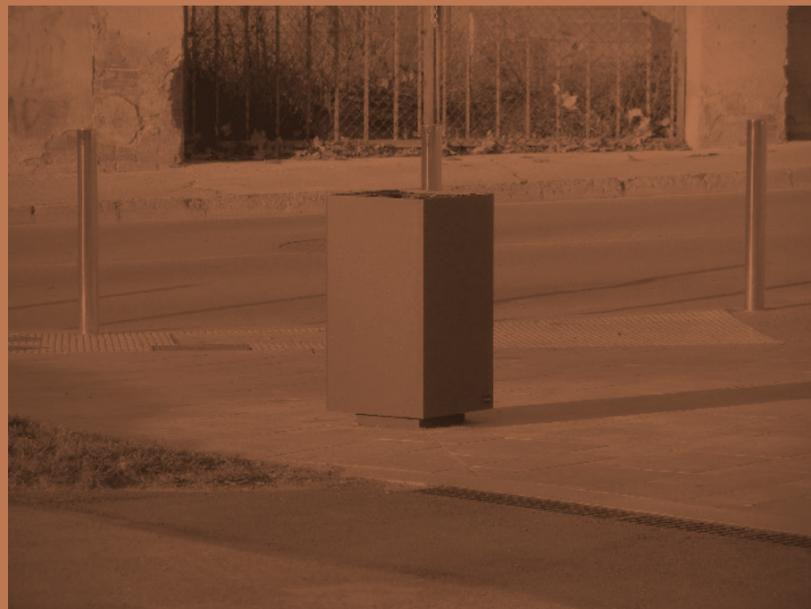
Sa poignée et son système d'extraction facilitent l'entretien et le nettoyage en milieu urbain. Réalisée en tôle usinée, pliée et soudée, elle est disponible en acier galvanisé avec apprêt antirouille et peinture en poudre ou en acier Corten grenailé. Autoportante, elle est facile à installer sur la chaussée grâce à quatre tiges de fixation.
