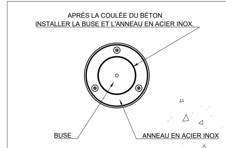
3 X 3/8" [10mm] TIGES D'ANCRAGE EN ACIER INOX. SERVENT À RÉGLER LA HAUTEUR ET LE NIVEAU. INSTALLÉES ET RECOUVERTES DE MORTIER EPOXYDE-CIMENT. (FAIT PAR L'INSTALLATEUR)
