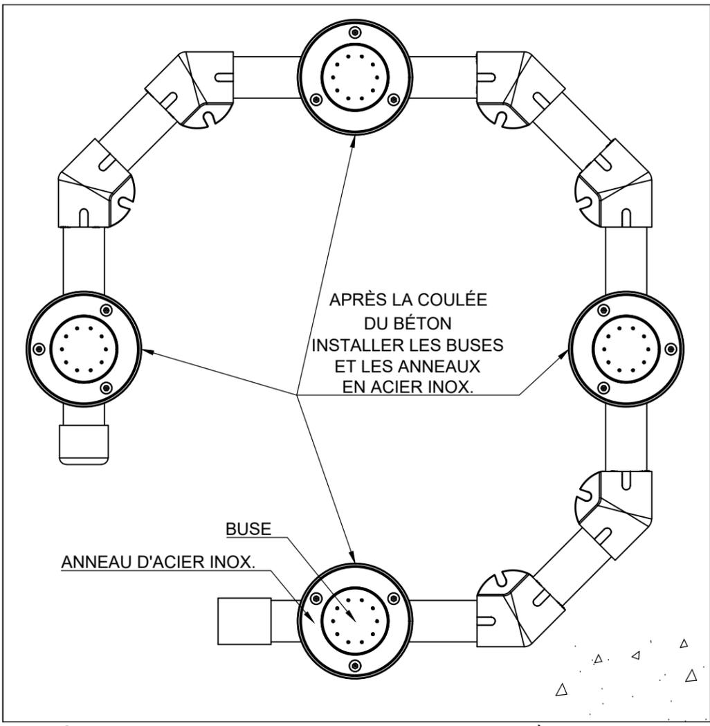
12 X 3/8" [10mm] TIGES D'ANCRAGE EN ACIER INOX. SERVENT À RÉGLER LA HAUTEUR ET LE NIVEAU. INSTALLÉES ET RECOUVERTES DE MORTIER EPOXYDE-CIMENT. (FAIT PAR L'INSTALLATEUR)
