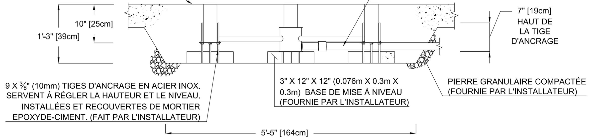
9 X 3/8" (10mm) TIGES D'ANCRAGE EN ACIER INOX. SERVENT À RÉGLER LA HAUTEUR ET LE NIVEAU. INSTALLÉES ET RECOUVERTES DE MORTIER EPOXYDE-CIMENT. (FAIT PAR L'INSTALLATEUR)
