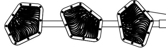
APRÈS AVOIR COULÉ LE BÉTON ET QUE LE BÉTON EST DURCI, ENLEVER LES COUVERCLES D'HIVERNISATION ET ASSEMBLER LE COUVERCLE HOP EN CAOUTCHOUC AVEC L'ANNEAU D'ENCADREMENT (LIVRÉ NON ASSEMBLÉ)
