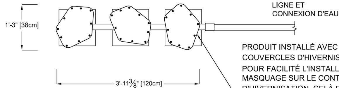
PRODUIT INSTALLÉ AVEC LES COUVERCLES D'HIVERNISATION ASSEMBLÉS. (MONTRÉ) POUR FACILITER L'INSTALLATION: AJOUTER DU RUBAN DE MASQUAGE SUR LE CONTOUR ET DESSUS DU COUVERCLE D'HIVERNISATION. CELÀ FACILITERA L'ENLEVEMENT DE CELUI-CI SUITE À LA COULÉE DE BÉTON
