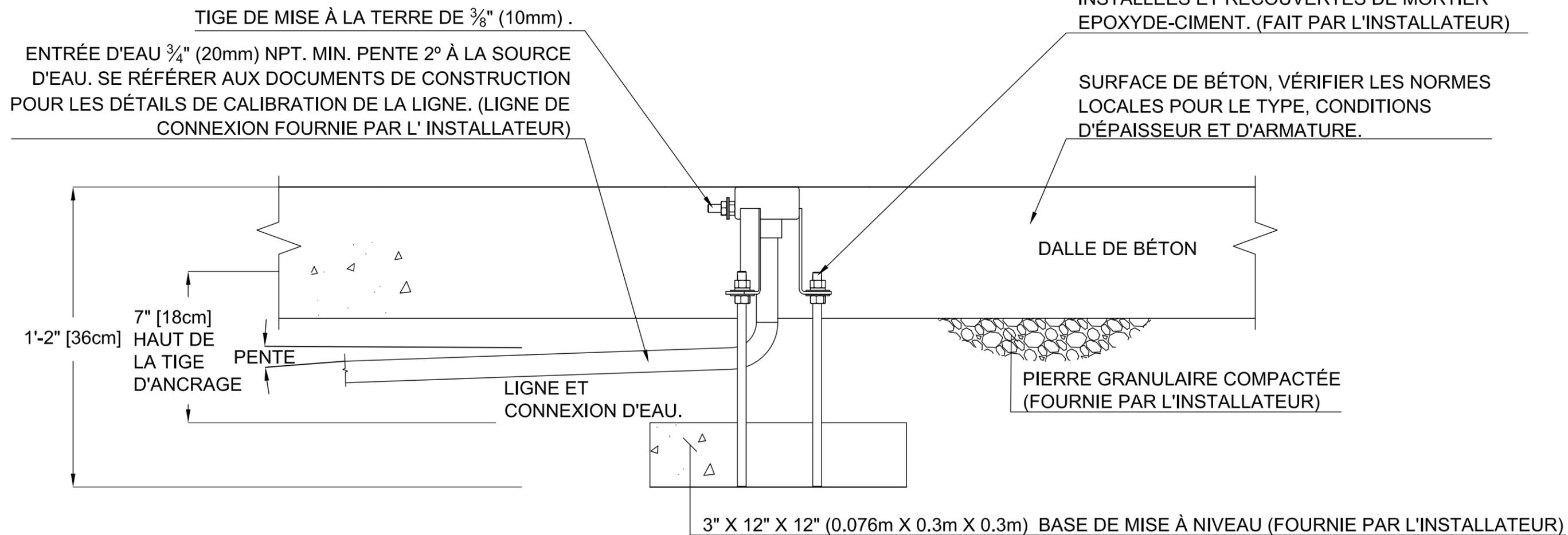
3 X 3/8" (10mm) TIGES D'ANCRAGE EN ACIER INOX. SERVENT À RÉGLER LA HAUTEUR ET LE NIVEAU.
